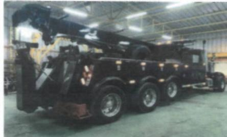
Que, de acuerdo al referido informe, el equipamiento se encuentra diseñado principalmente con una grúa rotativa que gira 360° en su base, y se encuentra ensamblada originalmente al chasis de la máquina, obedeciendo a los cálculos y diseño de ingeniería de la fábrica, haciendo posible la operatividad efectiva de levante, extensión y giro del sistema mecánico hidráulico, acorde a las dimensiones, con una capacidad de levante de 60 toneladas.
